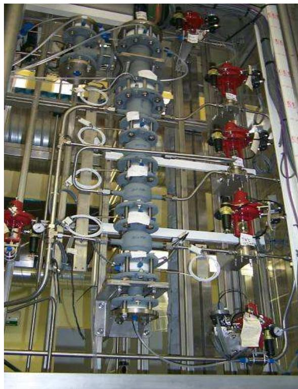
*Boucle de démonstration du procédé thermo-chimique Iode-Soufre pour la production massive d'H<sub>2</sub>, développée par la collaboration avec la Sandia, General Atomics (San Diego, CA) et le CEA/Marcoule*
